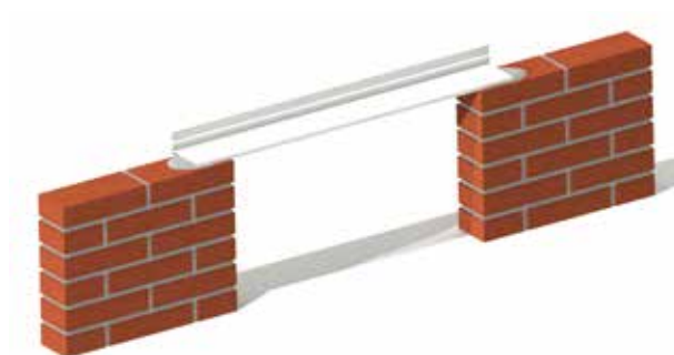
Muröppningsformen placeras i bruksplättar med min. 100 mm upplag på vardera sida.
