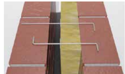
Montage av skalmurskramla nr. 10 i murverkets liggfogar. Horisontalsnitt.
